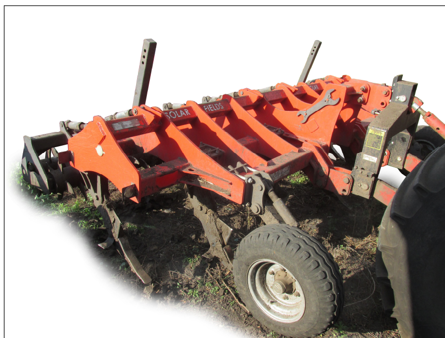
Рисунок 1 – Плуг чизельный торговой марки Solar Fields серии ПЧ(У), модели ПЧ-4(У)Н-03.00 EURO, вид спереди справа
