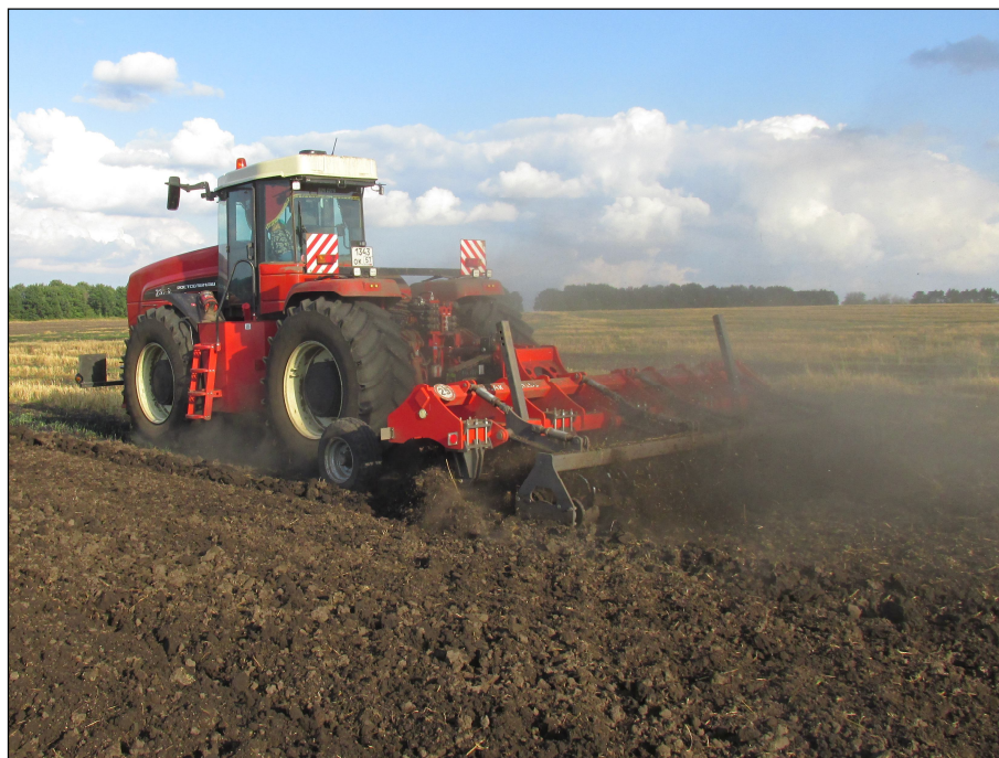
Рисунок 2 – Плуг чизельный торговой марки Solar Fields серии ПЧ(У), модели ПЧ-4(У)Н-03.00 EURO в агрегате с трактором RSM 2375, на безотвальном рыхлении почвы
