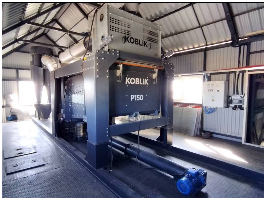
Рисунок 2 – Сепаратор высокопроизводительный типа "PROFI" серии Р модель Р150, на предварительной очистке зернового вороха подсолнечника
