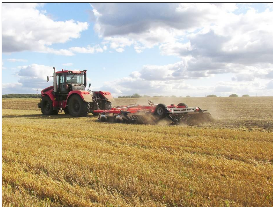
Рисунок 2 – Дисковая борона, торговой марки "Solar Fields", модели БД-6×4ПК-03.00 EURO, в агрегате с трактором К-742 МСт "Кировец" на дисковом лущении стерни озимой пшеницы (1 след)
