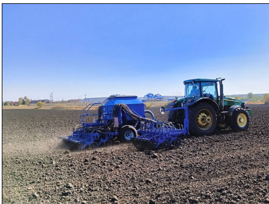
Рисунок 3 – Сеялка С-7,2 ПМ2 в агрегате с трактором John Deere 7820, на посеве семян гороха
