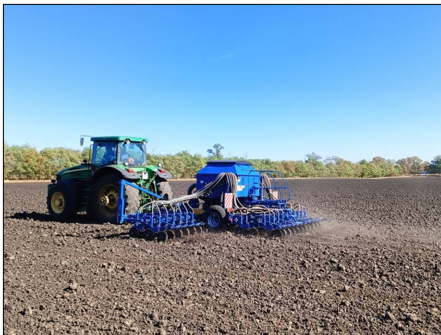
Рисунок 2 – Сеялка С-7,2 ПМ2 в агрегате с трактором John Deere 7820, на посеве озимого ячменя
