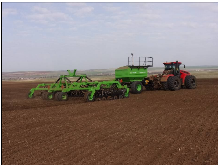
Рисунок 2 – Посевной комплекс "Дон-657", в агрегате с трактором К-742 МСт1 "Кировец", на посеве горчицы
