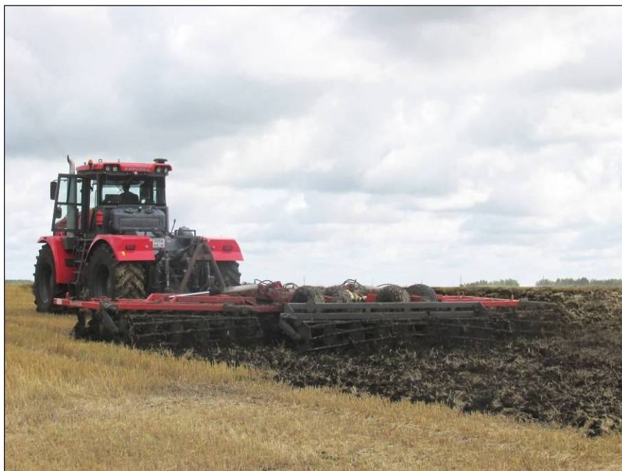
Рисунок 2 – Дисковая борона, торговой марки Solar Fields, модели БД-8×3ПК-03.00 EURO в агрегате с трактором К-742 Ст "Кировец" на дисковом лущении стерни озимой пшеницы (1 след)
