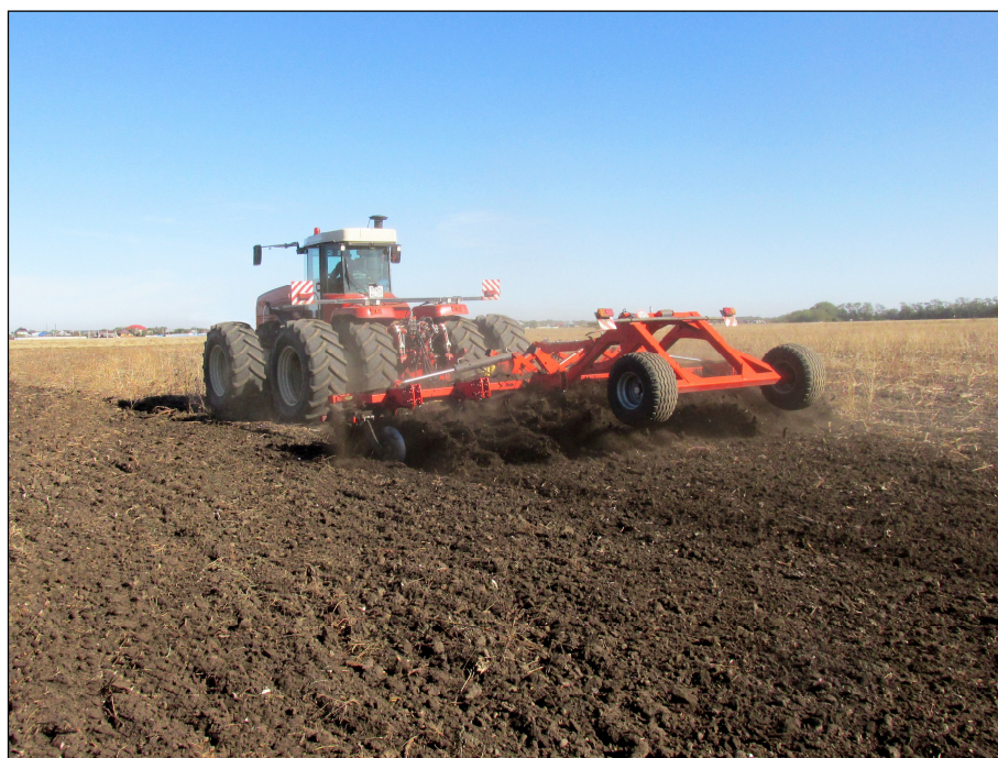
Рисунок 2 – Дисковая борона, торговой марки "Solar Fields", модели ЛД-7ПК-03.00 EURO, в агрегате с трактором Ростсельмаш 2375 на дисковом лушении стерни озимой пшеницы (2 след)
