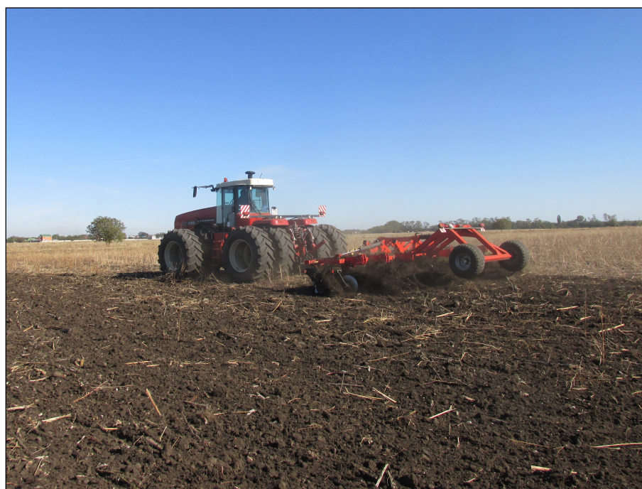
Рисунок 3 – Дисковая борона, торговой марки "Solar Fields", модели ЛД-7ПК-03.00 EURO, в агрегате с трактором Ростсельмаш 2375 на дисковом лушении пожнивных остатков подсолнечника (2 след)
