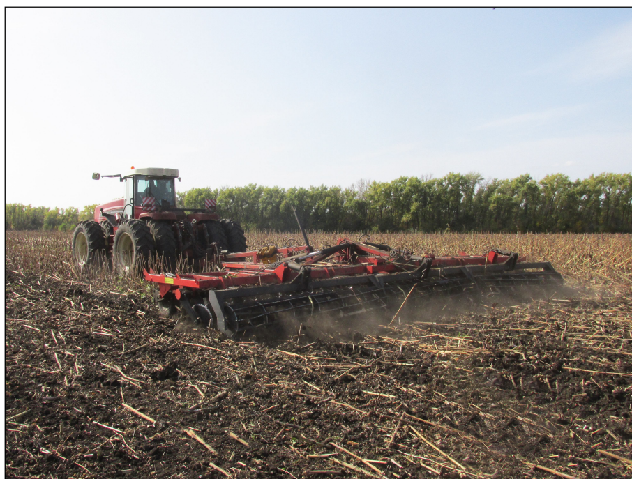
Рисунок 3 – Дисковая борона, торговой марки "Solar Fields", модели ЛД-9ПК-03.00, в агрегате с трактором Ростсельмаш 2375 на дисковом лущении пожнивных остатков подсолнечника (1 след)
