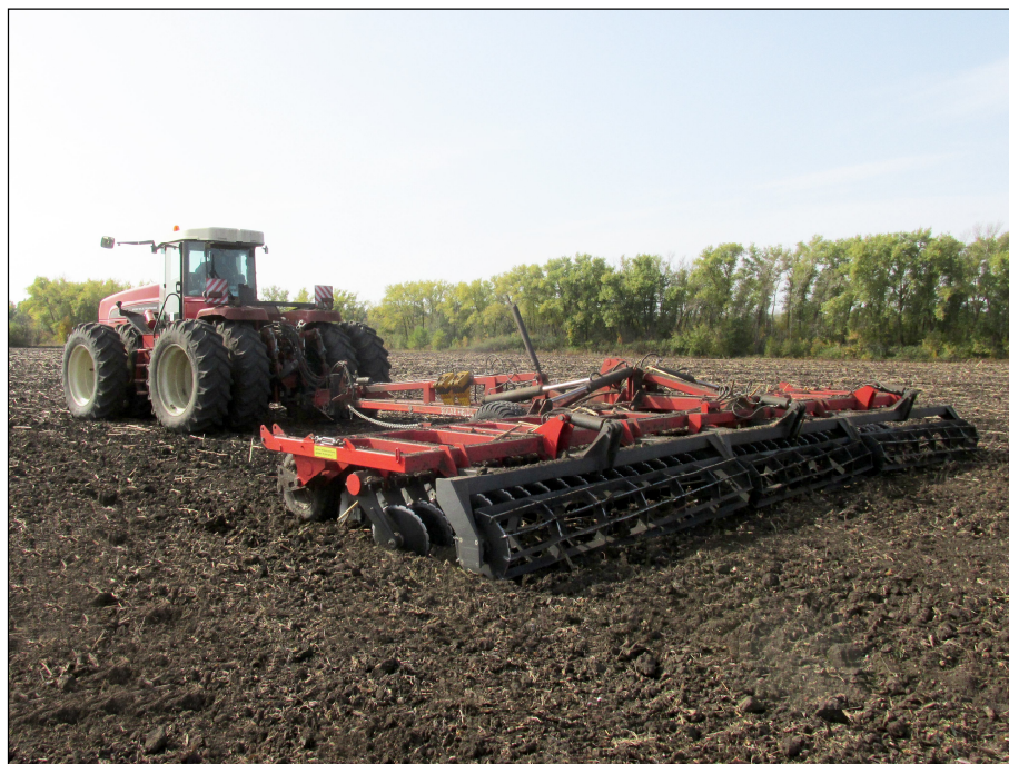
Рисунок 2 – Дисковая борона, торговой марки "Solar Fields", модели ЛД-9ПК-03.00, в агрегате с трактором Ростсельмаш 2375 на дисковом лущении стерни озимой пшеницы (2 след)
