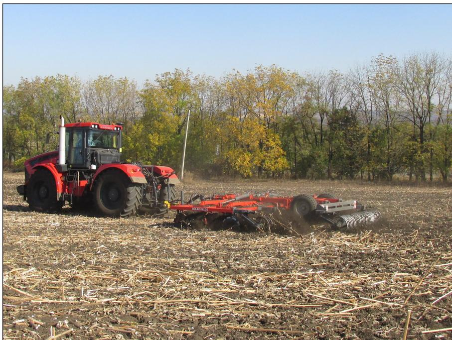
Рисунок 3 – Дисковая борона, торговой марки Solar Fields, модели БД-7×3ПК-03.00 EURO в агрегате с трактором К-742 М "Кировец" на дисковом лущении пожнивных остатков подсолнечника (1 след)
