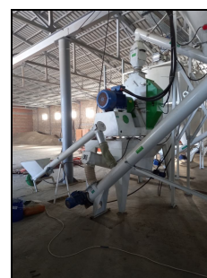
Дробилка роторная ДЗМ-6У на измельчении зерносмеси в линии кормоцеха
