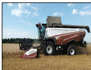
Комбайн зерноуборочный самоходный РСМ-154 "Т-500" с жаткой РСМ-161.27 на прямом комбайнировании озимой пшеницы
