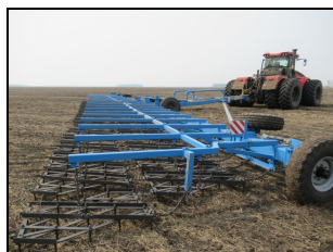
Сцепка борон гидрофицированная "Заря" СБГ-22-2 с навешанными зубowymi боронами
