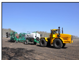
Посевной комплекс "Кузбасс" ПК-8,5 в агрегате с тракто- ром K-700
