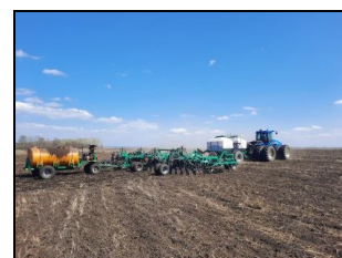
Посевной комплекс "Кузбасс-Т" ПК-12,2 в агрегате с трактором New Holland T9040 и установкой для внесения жидких удобрений "УЖУ" на посеве яровой пшеницы
