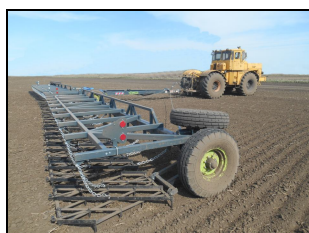
Сцепка гидрофицированная СГС-21, в агрегате с трактором К-700А на ранневесеннем бороновании почвы
