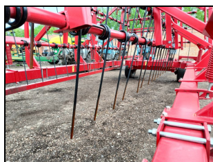
Рабочие органы - пружинные зубья
