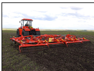
Культиватор "Landmaster-8500" в агрегате с трактором Т-360 на предпосевной обработке почвы
