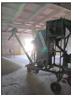
Машина зерноочистительная универсальная МЗК-7С на очистке пшеницы
