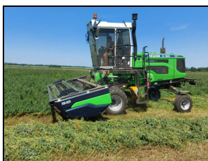
Самоходная косилка-плющилка "Мещера Е-403" с жаткой кормовой SH-025 на скашивании клевера
