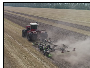
Чизельно-дисковый агрегат ЧДА-6,2.П в агрегате с трактором RSM 3435 на безотвальной обработке почвы
