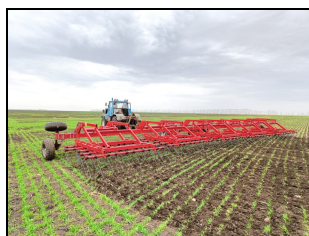
Борона пружинная БП-15 в агрегате с трактором ХТЗ-150К, на боронировании озимых посевов
