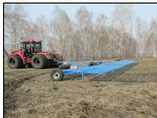
Сцепка борон гидрофицированная "Заря" СБГ-22-2 в агрегате с трактором К-744 Р4 на весеннем предпосевном бороновании почвы
