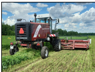
Косилка валковая транспортерная КВТ 9-18 "Draper Flow 900" совместно с шасси самоходным для уборочных машин ШС-150 на скашивании трав и укладке срезанной массы в центральный валок
