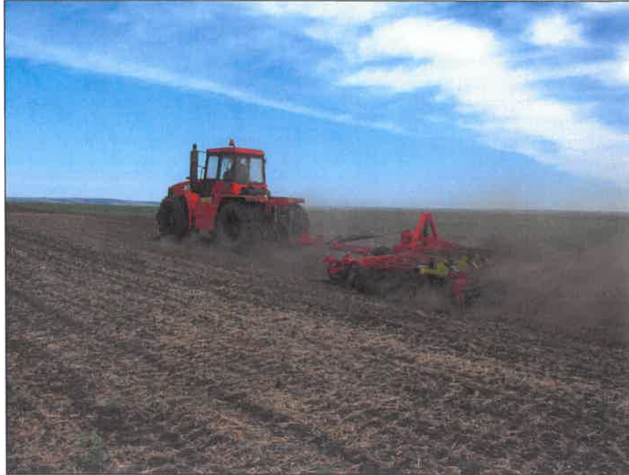
Рисунок 2 – Средний предпосевной культиватор "Tillermaster-6200" в агрегате с трактором Т-360 Agromaster на сплошной культивации почвы
