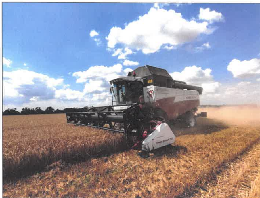
Рисунок 2 – Комбайн зерноуборочный самоходный PCM-152 "ACROS-595 Plus", на прямом комбайнировании озимой пшеницы
