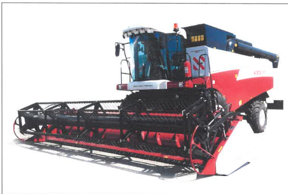
Рисунок 1 – Комбайн зерноуборочный самоходный РСМ-152 "ACROS-595 Plus"
