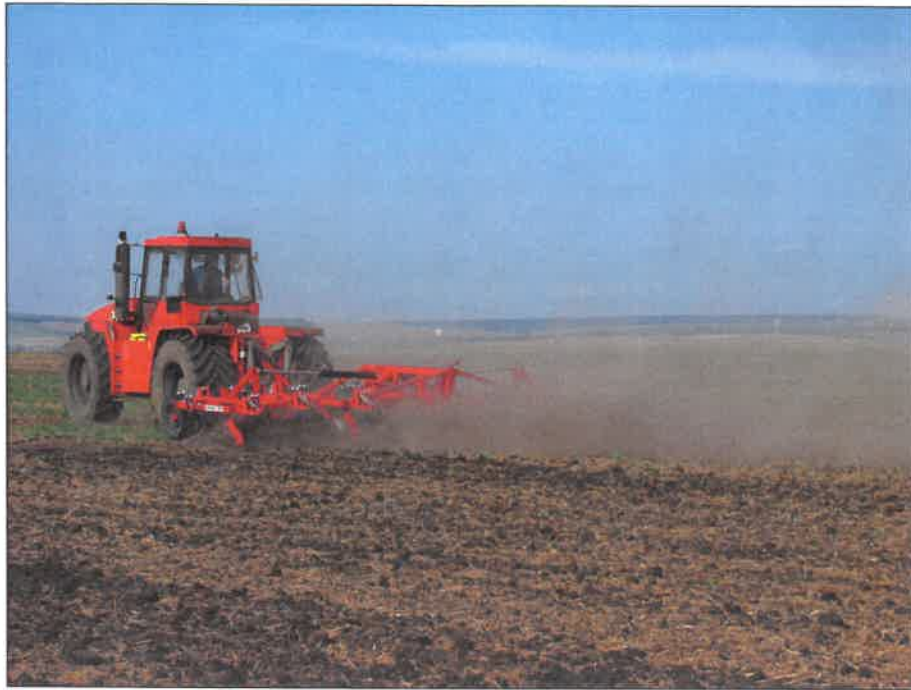
Рисунок 2 – Культиватор "Landmaster-12200" в агрегате с трактором Т-360 Agromaster, на сплошной культивации почвы
