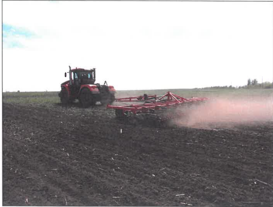
Рисунок 2 – Культиватор сплошной, серии КС(У), модели КС-12(У)-03.00 EURO в агрегате с трактором К-739 МСт-1 "Кировец", на предпосевной культивации почвы
