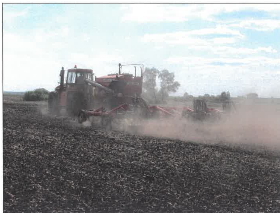
Рисунок 3 – Комбинированный посевной комплекс "Agrator KZS-8500", в агрегате с трактором Т-360 Agromaster на посеве семян гороха
