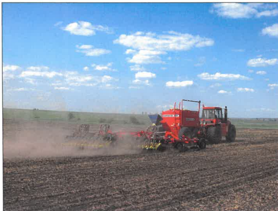
Рисунок 4 – Комбинированный посевной комплекс "Agrator KZS-8500", в агрегате с трактором Т-360 Agromaster на посеве семян рапса
