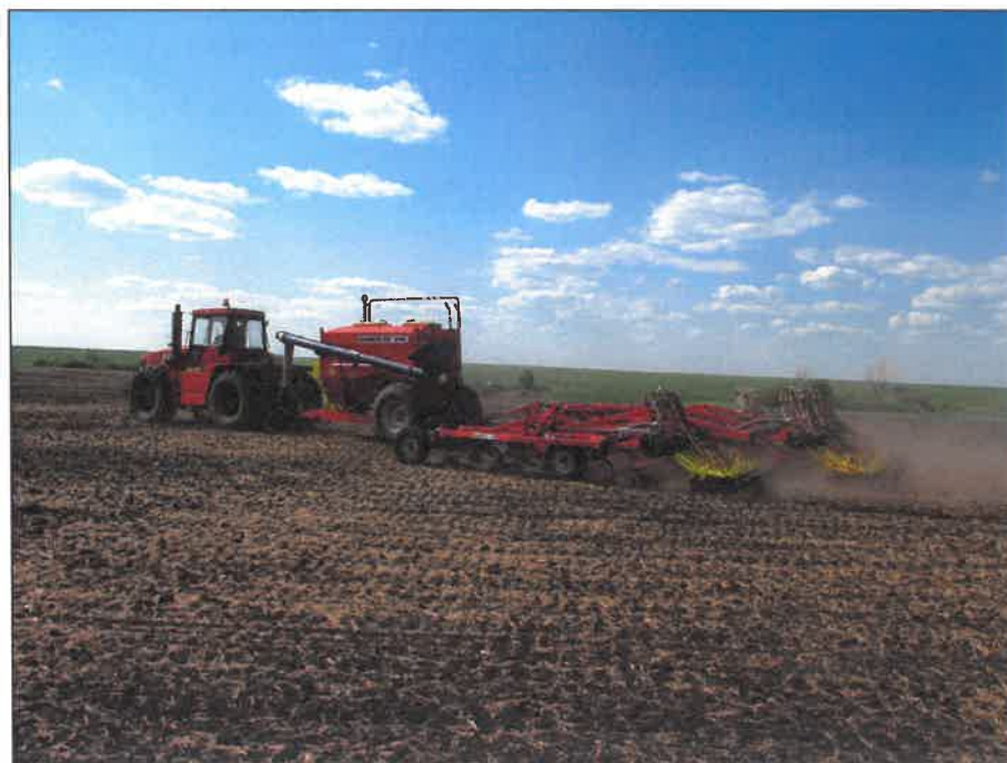
Рисунок 2 – Комбинированный посевной комплекс "Agrator KZS-8500", в агрегате с трактором Т-360 Agromaster на посеве семян пшеницы
