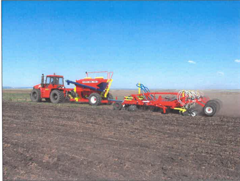
Рисунок 4 – Комбинированный посевной комплекс "Agrator - combi 9000", в агрегате с трактором Т-360 Agromaster, на посеве рапса
