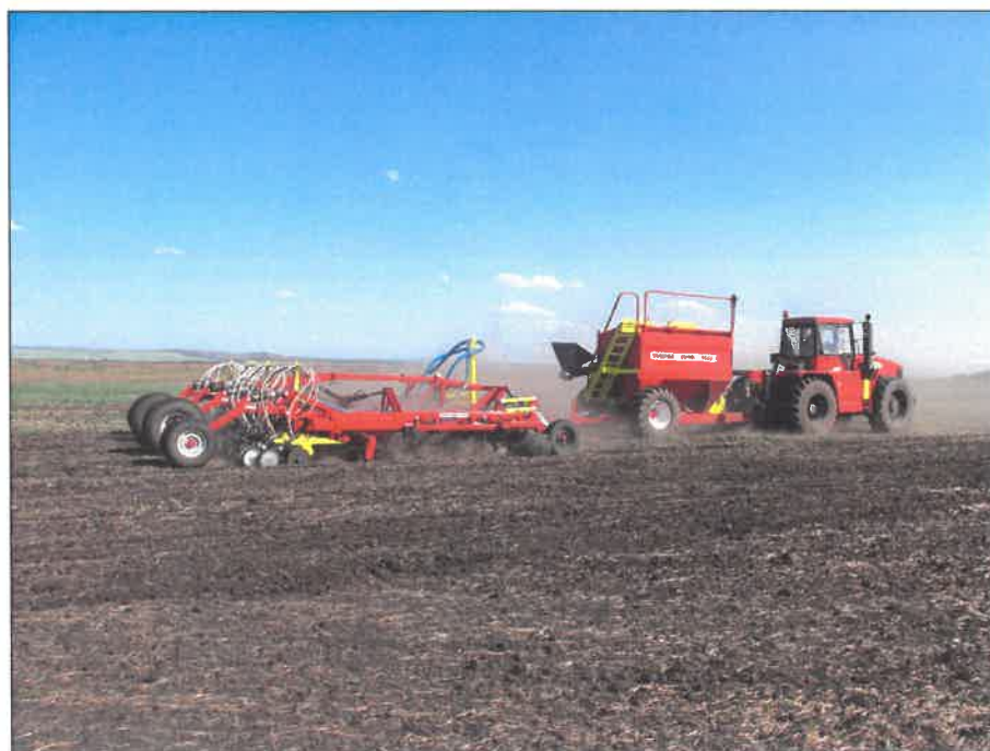
Рисунок 3 – Комбинированный посевной комплекс "Agrator - combi 9000", в агрегате с трактором Т-360 Agromaster, на посеве гороха
