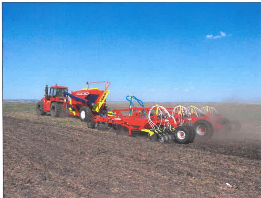
Рисунок 2 – Комбинированный посевной комплекс "Agrator - combi 9000", в агрегате с трактором Т-360 Agromaster, на посеве озимой пшеницы
