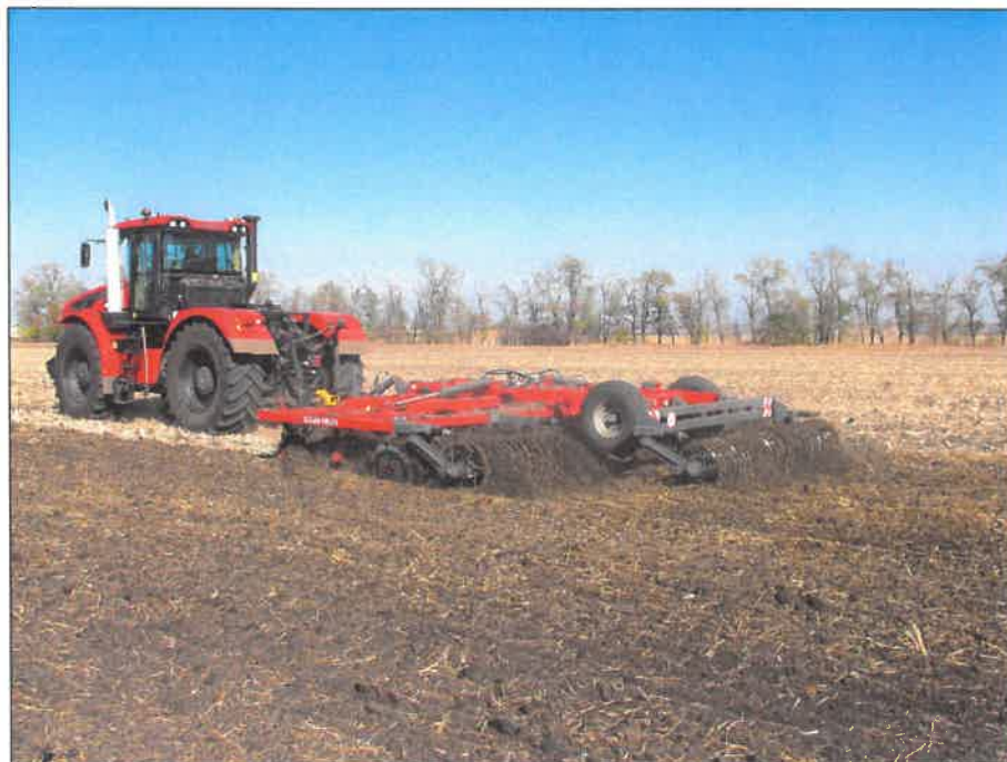
Рисунок 2 – Дисковая борона, торговой марки Solar Fields, модели БД-7×3ПК-03.00 EURO в агрегате с трактором К-742 М "Кировец" на дисковом лущении стерни озимой пшеницы (2 след)
