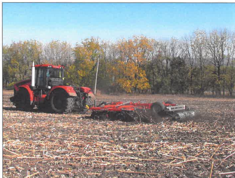
Рисунок 3 – Дисковая борона, торговой марки Solar Fields, модели БД-7×3ПК-03.00 EURO в агрегате с трактором К-742 М "Кировец" на дисковом лущении пожнивных остатков подсолнечника (1 след)
