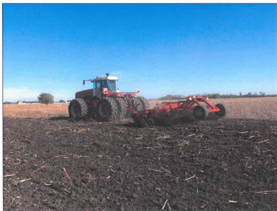
Рисунок 3 – Дисковая борона, торговой марки "Solar Fields", модели ЛД-7ПК-03.00 EURO, в агрегате с трактором Ростсельмаш 2375 на дисковом лущении пожнивных остатков подсолнечника (2 след)
