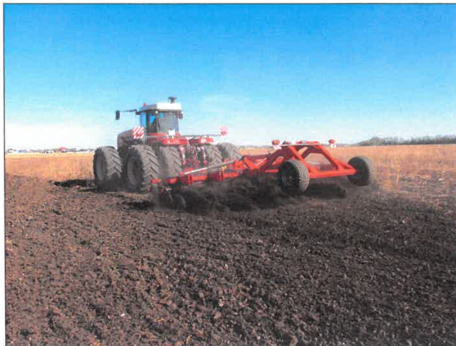
Рисунок 2 – Дисковая борона, торговой марки "Solar Fields", модели ЛД-7ПК-03.00 EURO, в агрегате с трактором Ростсельмаш 2375 на дисковом лущении стерни озимой пшеницы (2 след)
