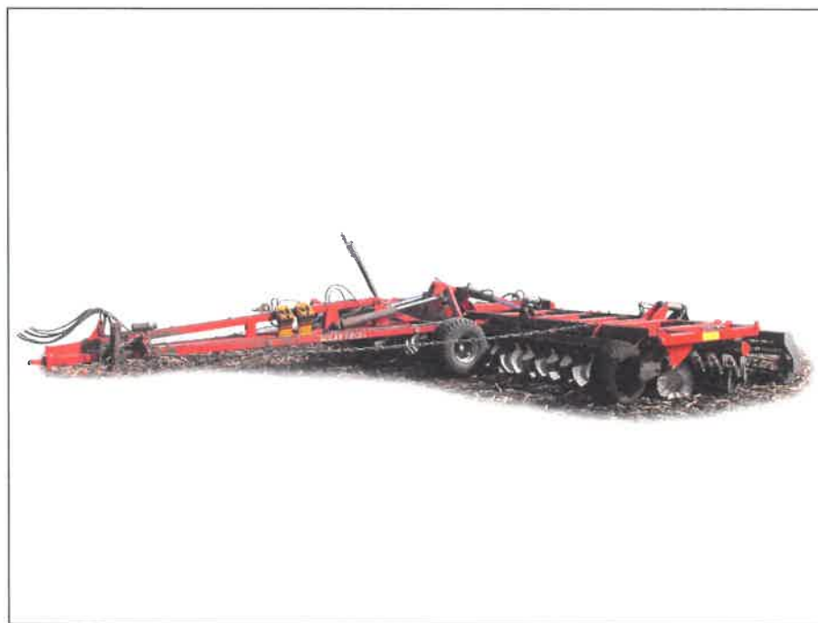
Рисунок 1 – Дисковая борона, торговой марки "Solar Fields", модели ЛД-9ПК-03.00, вид спереди слева
