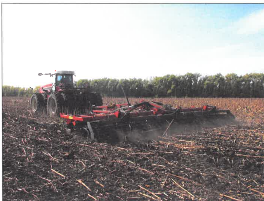
Рисунок 3 – Дисковая борона, торговой марки "Solar Fields", модели ЛД-9ПК-03.00, в агрегате с трактором Ростсельмаш 2375 на дисковом лушении пожнивных остатков подсолнечника (1 след)
