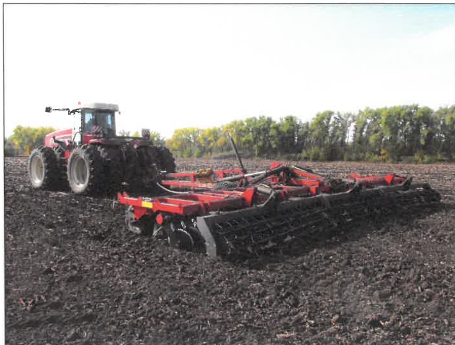
Рисунок 2 – Дисковая борона, торговой марки "Solar Fields", модели ЛД-9ПК-03.00, в агрегате с трактором Ростсельмаш 2375 на дисковом лушении стерни озимой пшеницы (2 след)
