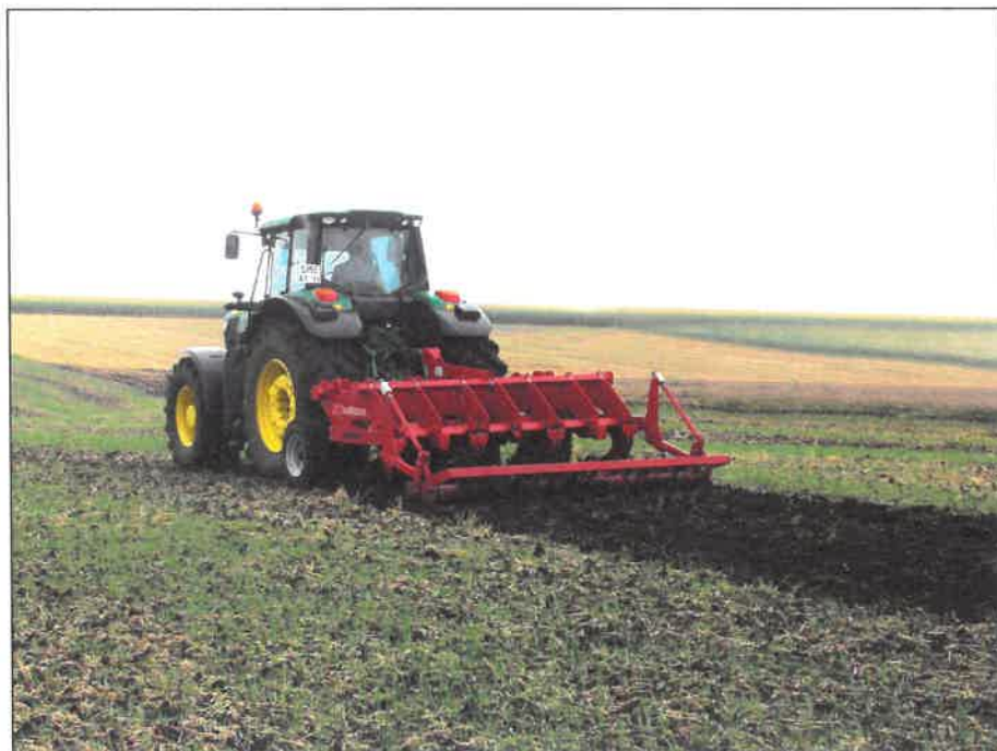
Рисунок 2 – Глубокорыхлитель КАМА TIGER 3 в агрегате с трактором John Deere 6195M, на безотвальном глубоком рыхлении почвы
