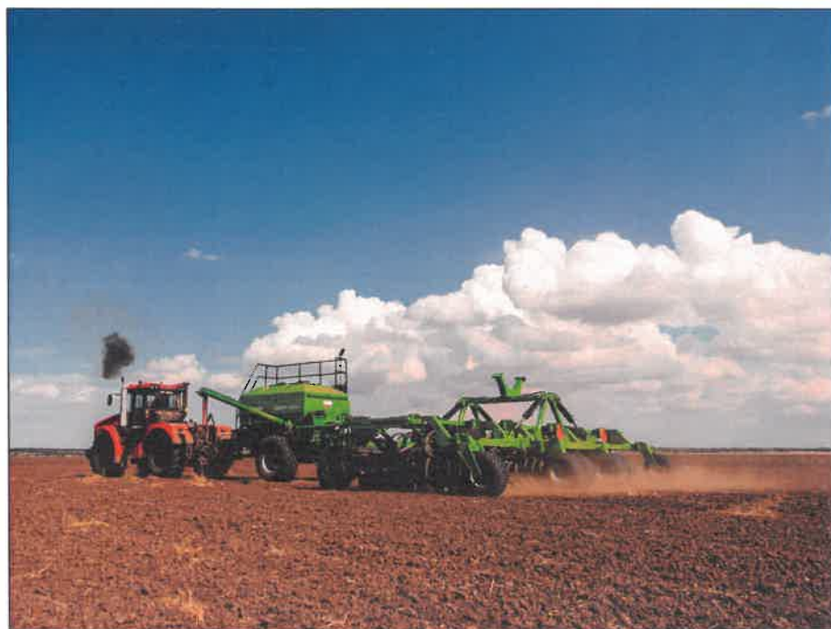
Рисунок 3 – Посевной комплекс "Дон-651" (анкерный), в агрегате с трактором К-742 МСт1 "Кировец", на посеве семян гороха
