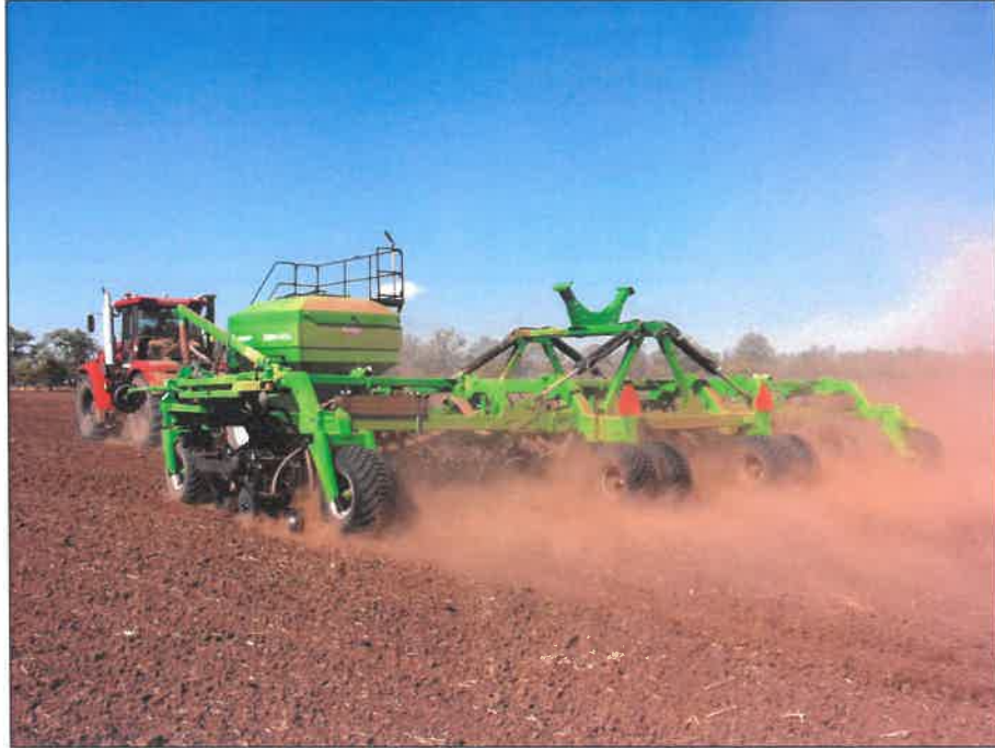
Рисунок 4 – Посевной комплекс "Дон-651" (анкерный), в агрегате с трактором К-742 МСт1 "Кировец", на посеве семян люцерны
