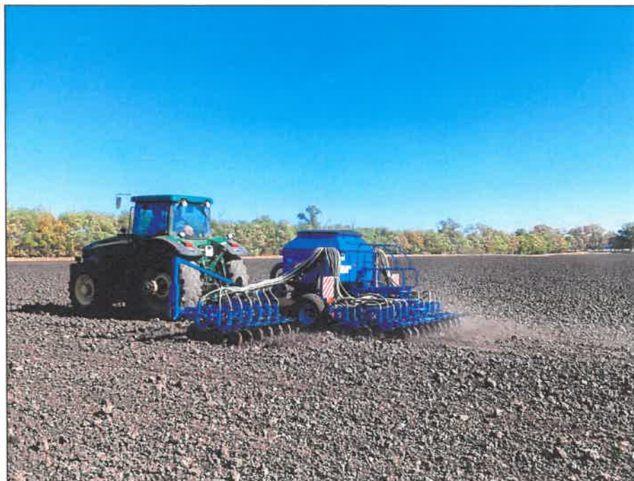
Рисунок 2 – Сеялка С-7,2 ПМ2 в агрегате с трактором John Deere 7820, на посеве озимого ячменя
