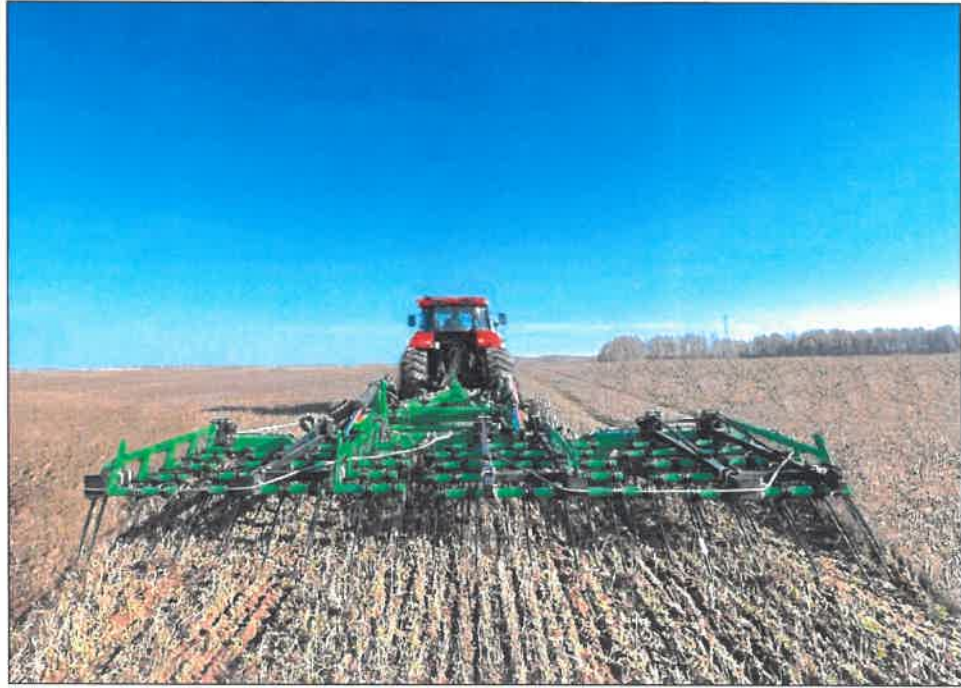
Рисунок 2 – Борона тяжелая стерневая КАМА LION 7,2 в агрегате с трактором Беларус 922.3 на поверхностном рыхлении почвы, уничтожении сорняков и частичной заделке пожнивных остатков
