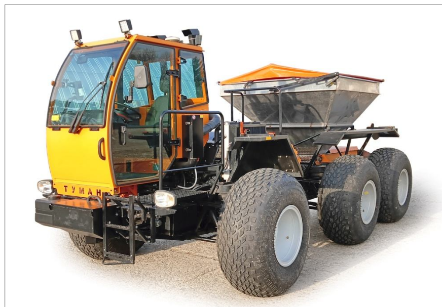
Рисунок 1 – Опрыскиватель-разбрасыватель самоходный Туман-2М комплектуемый сменным технологическим оборудованием (разбрасывателем Туман-2), вид спереди слева
