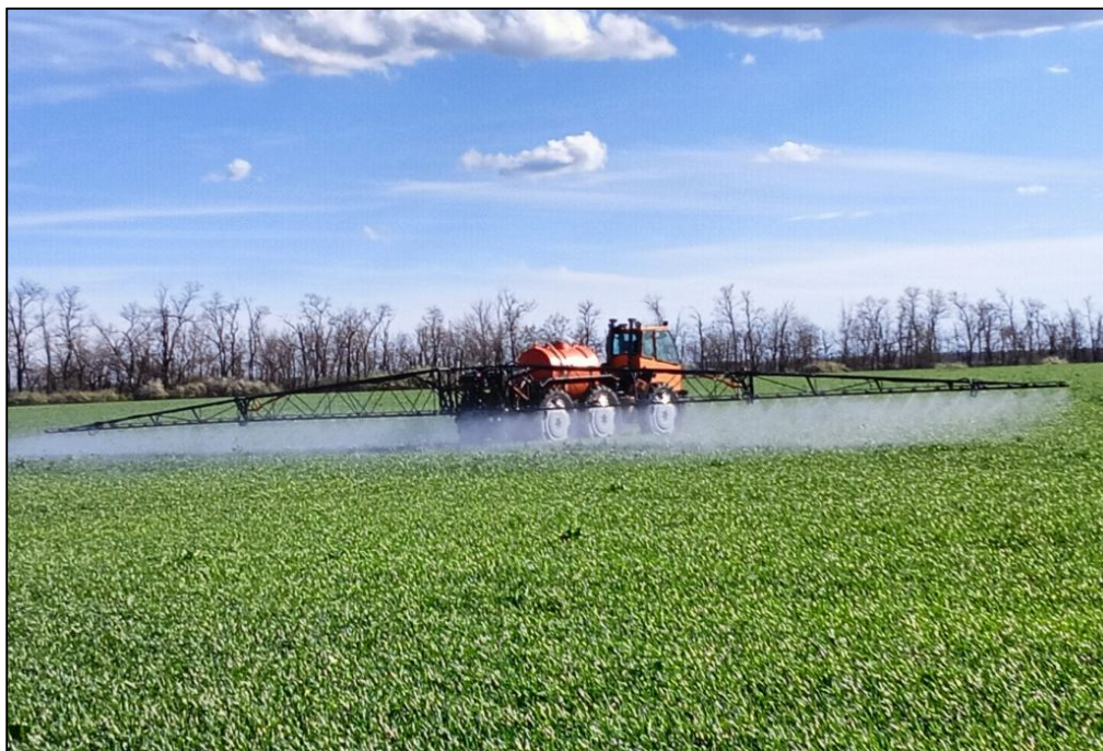
Рисунок 2 – Опрыскиватель-разбрасыватель самоходный Туман-2М комплектуемый сменным технологическим оборудованием (штанговым опрыскивателем Туман-2), в работе на опрыскивании озимой пшеницы
