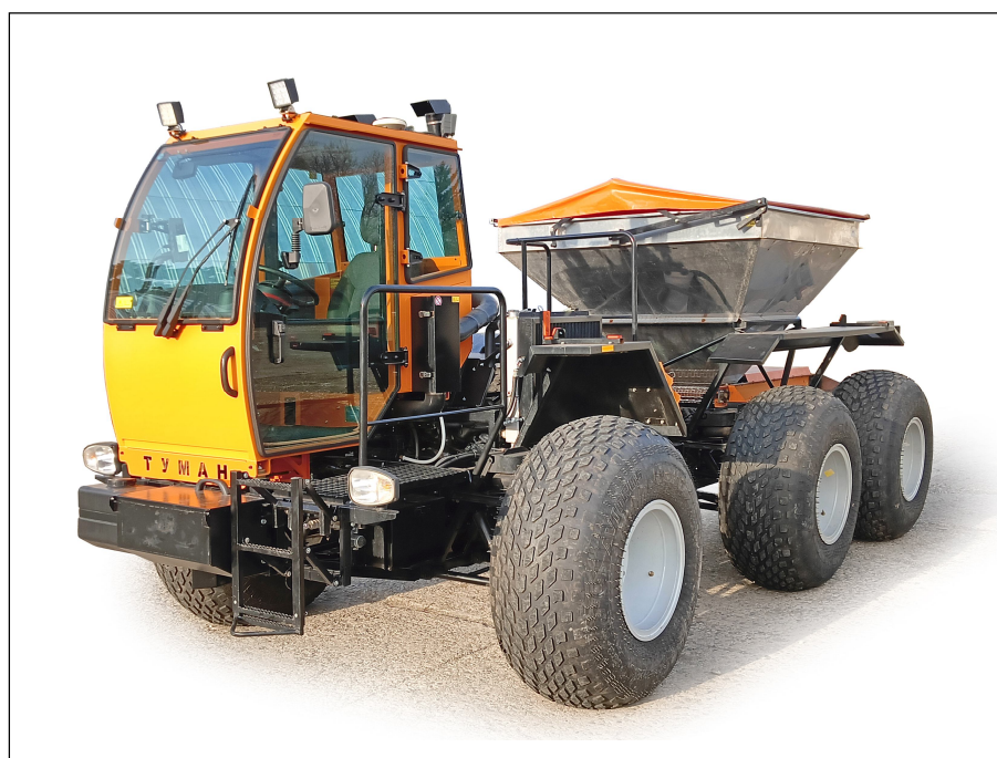
Рисунок 1 – Опрыскиватель-разбрасыватель самоходный ТУМАН-2М, комплектуемый сменным технологическим оборудованием (разбрасывателем ТУМАН-2), вид спереди слева
