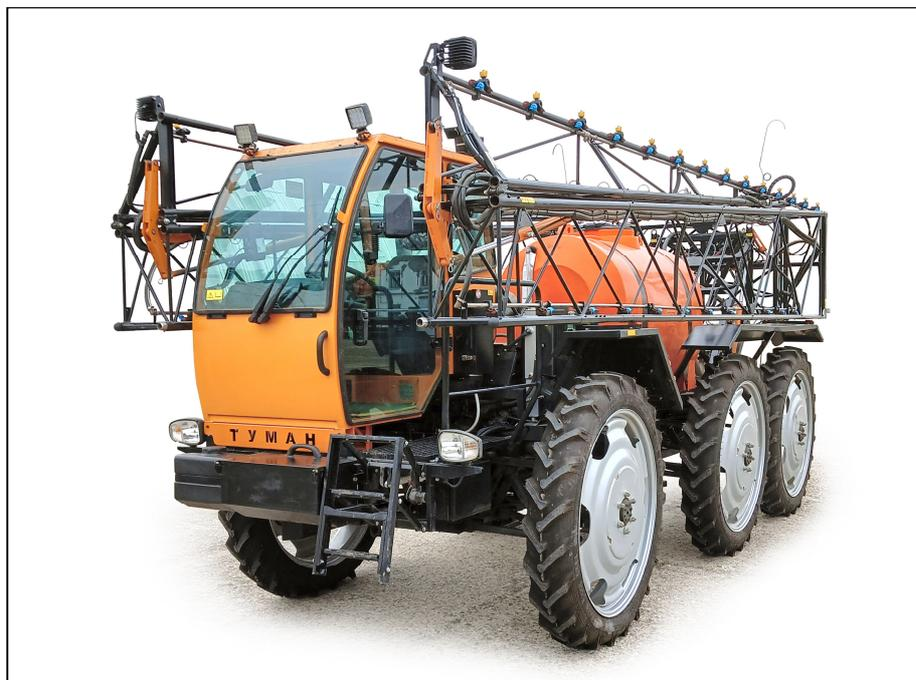
Рисунок 1 – Опрыскиватель-разбрасыватель самоходный ТУМАН-2М комплектуемый сменным технологическим оборудованием (штанговым опрыскивателем ТУМАН-2), вид спереди слева
