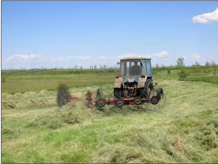
Рисунок 2 – Грабли колесно-пальцевые ГСП-600-01 "Kolibri V Plus" в агрегате с трактором МТЗ-80 на сгребании трав из прокосов в валки, оборачивании и ворошении валков сена
