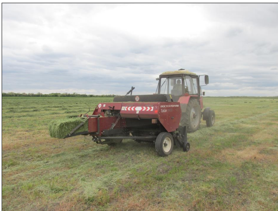
Рисунок 2 – Пресс-подборщик тюковый ППТ-041 "Tukan" в агрегате с трактором Беларус 892 на подборе и прессовании валков сена в тюки с обвязкой их шпагатом
