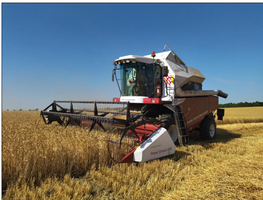
Рисунок 2 – Комбайн зерноуборочный самоходный S300 "NOVA-340", на прямом комбайнировании озимой пшеницы
