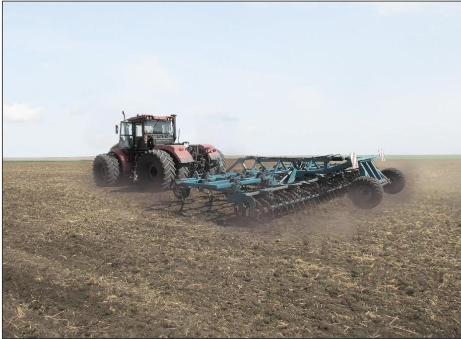
Рисунок 2 – Культиватор стерневой средний полуприцепной складной КСС-9000 М2 "Олимп" в агрегате с трактором К-744 Р1 "Кировец", на поверхностной обработке почвы
