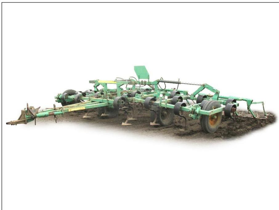
Рисунок 1 – Культиватор для сплошной обработки
