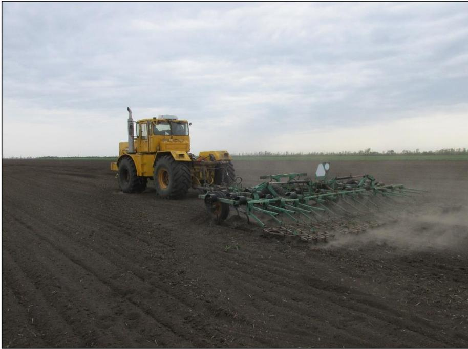
Рисунок 2 – Культиватор для сплошной обработки
