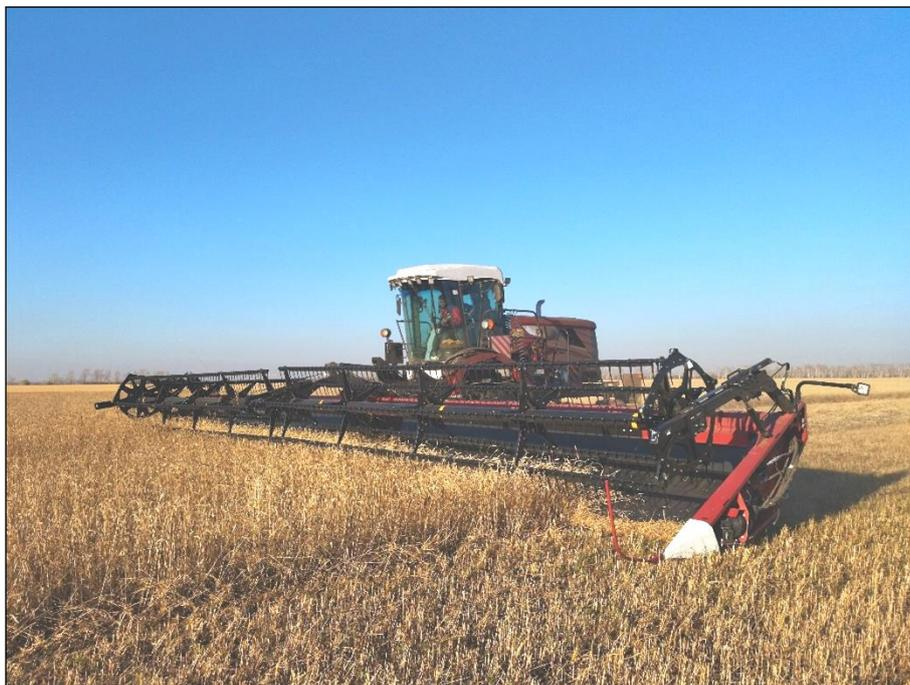
Рисунок 2 – Косилка валковая транспортерная КВТ-2 "Draper Flow 1400" в агрегате с косилкой самоходной универсальной КСУ-2 на скашивании и укладке в валок яровой пшеницы
