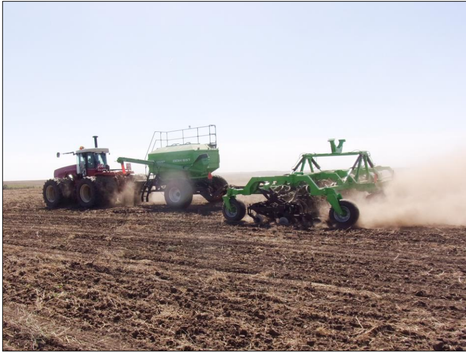
Рисунок 4 – Посевной комплекс Дон 657 (анкерный), в агрегате с трактором RSM 2375, на посеве озимой пшеницы
