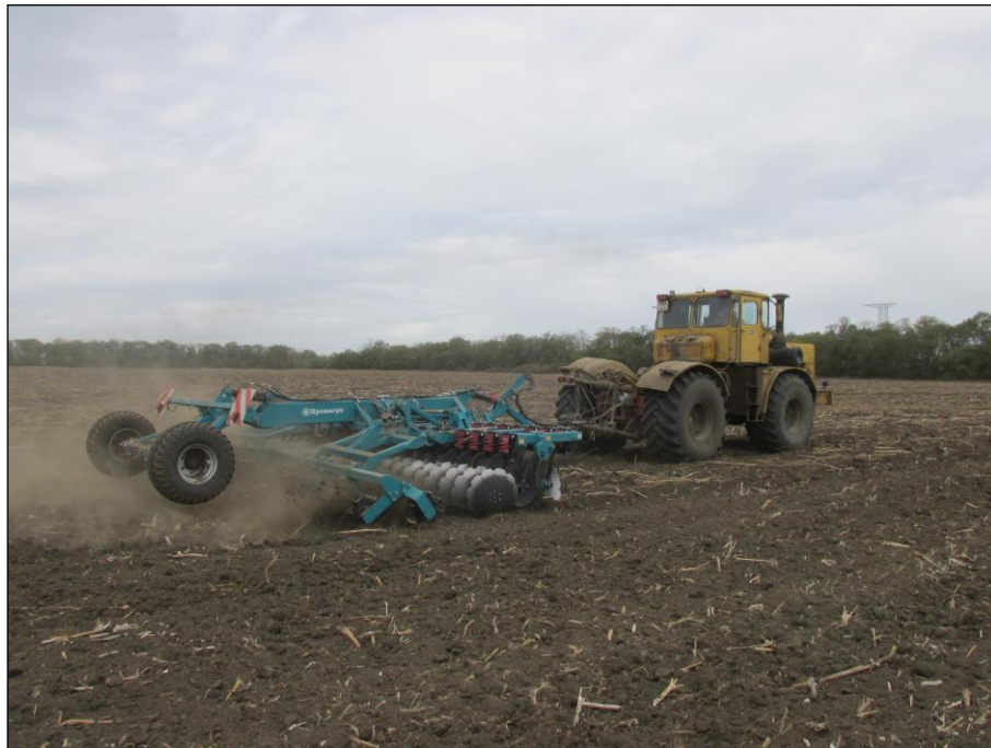
Рисунок 2 – Борона дисковая легкая полуприцепная складная ДЛ-620ПС М "Форвард" в агрегате с трактором К-701 "Кировец" на дисковом лущении пожнивных остатков подсолнечника (2 след)
