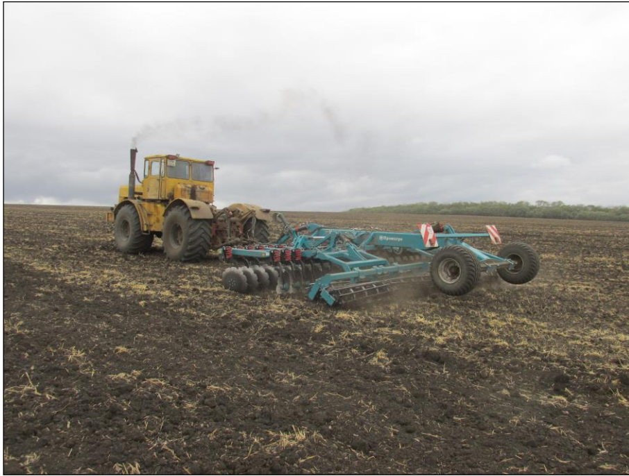
Рисунок 2 – Борона дисковая легкая полуприцепная складная ДЛ-620ПС М "Форвард" в агрегате с трактором К-701 "Кировец" на дисковом лущении стерни озимой пшеницы (2 след)
