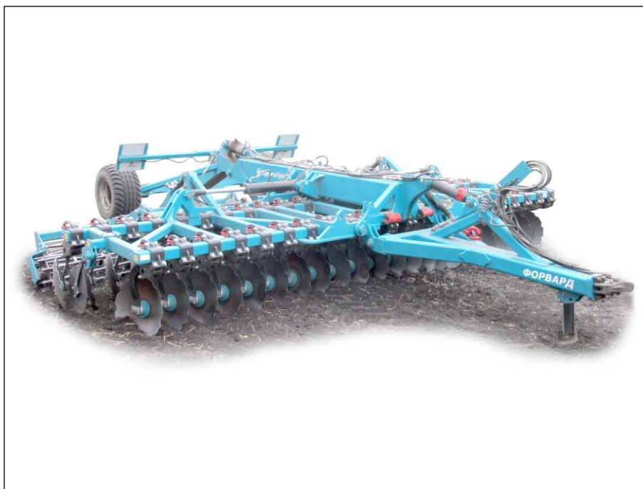
Рисунок 1 – Борона дисковая легкая полуприцепная складная ДЛ-620ПС М "Форвард", вид спереди справа
