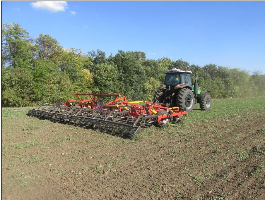
Рисунок 2 – Культиватор КСКП-8 в агрегате с трактором UMG T2204, на паровой обработке почвы
