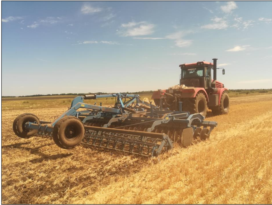
Рисунок 2 – Агрегат дисковый "TIGARBO" АДС-7, в агрегате К744РЗ на дисковом лущении стерни озимой пшеницы (1 след)
