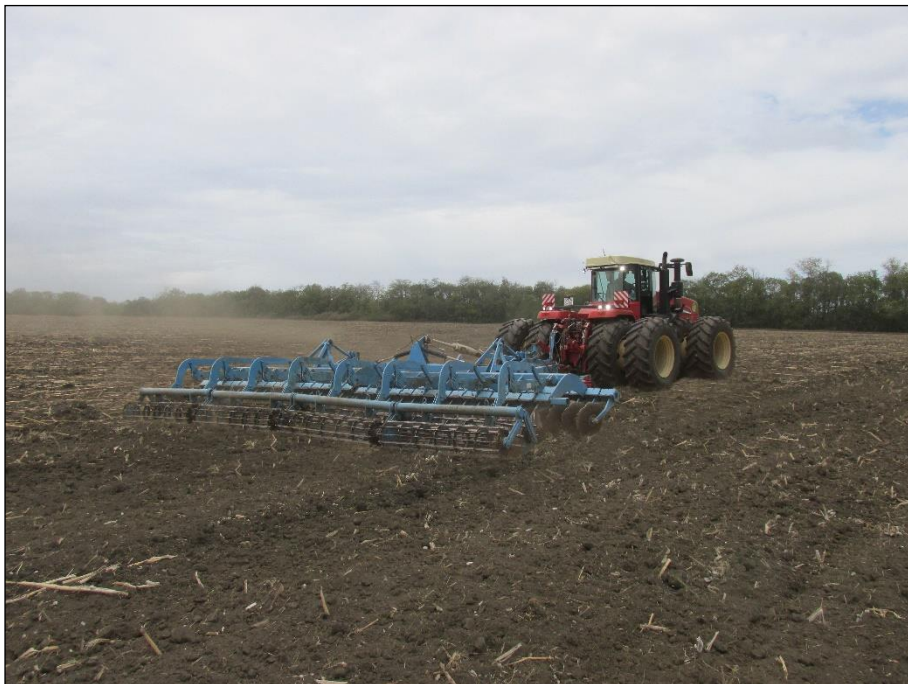
Рисунок 3 – Агрегат дисковый "TIGARBO" АДС-8 в агрегате с трактором RSM 2375 на дисковом лущении пожнивных остатков подсолнечника (2 след)
