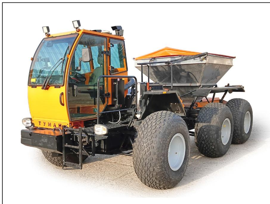
Рисунок 1 – Опрыскиватель-разбрасыватель самоходный ТУМАН-2М, комплектуемый сменным технологическим оборудованием (разбрасывателем ТУМАН-2), вид спереди слева
