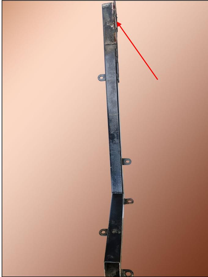
Рисунок 2 – Кронштейн крепления защитного приспособления (крыло) заднего колеса
