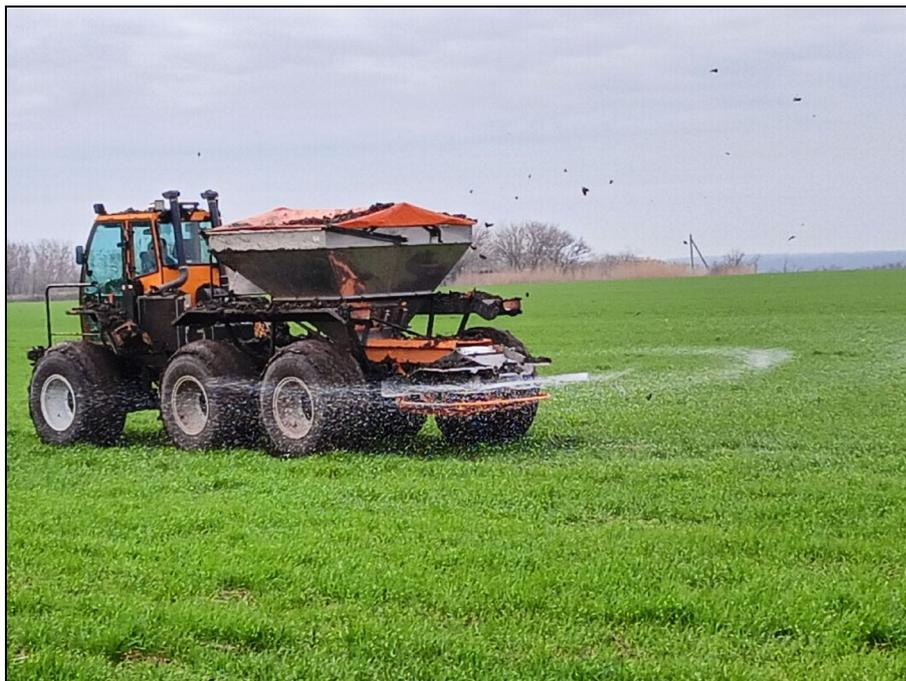
Рисунок 2 – Опрыскиватель-разбрасыватель самоходный ТУМАН-2М, комплектуемый сменным технологическим оборудованием (разбрасывателем ТУМАН-2), на внесении аммиачной селитры под озимую пшеницу
