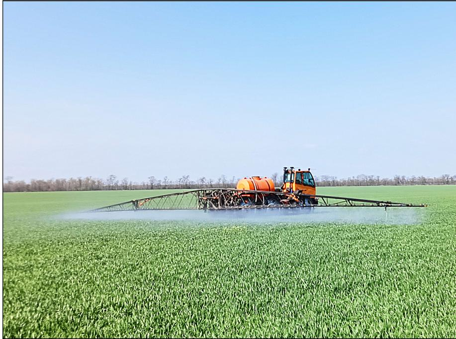
Рисунок 2 – Опрыскиватель-разбрасыватель самоходный ТУМАН-2М комплектуемый сменным технологическим оборудованием (штанговым опрыскивателем ТУМАН-2), на опрыскивании озимой пшеницы
