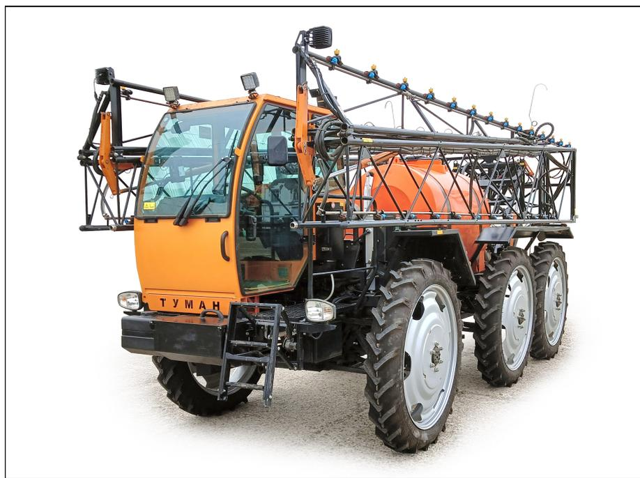
Рисунок 1 – Опрыскиватель-разбрасыватель самоходный ТУМАН-2М комплектующий сменным технологическим оборудованием (штанговым опрыскивателем ТУМАН-2), вид спереди слева
