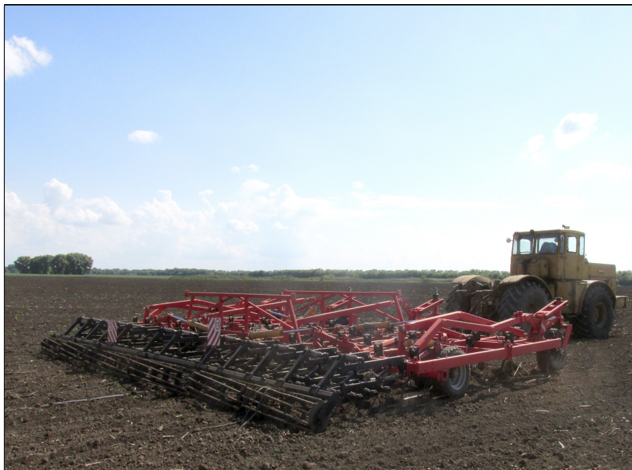
Рисунок 2 – Культиватор КСК-10,0 в агрегате с трактором К-701 на предпосевной обработке почвы
