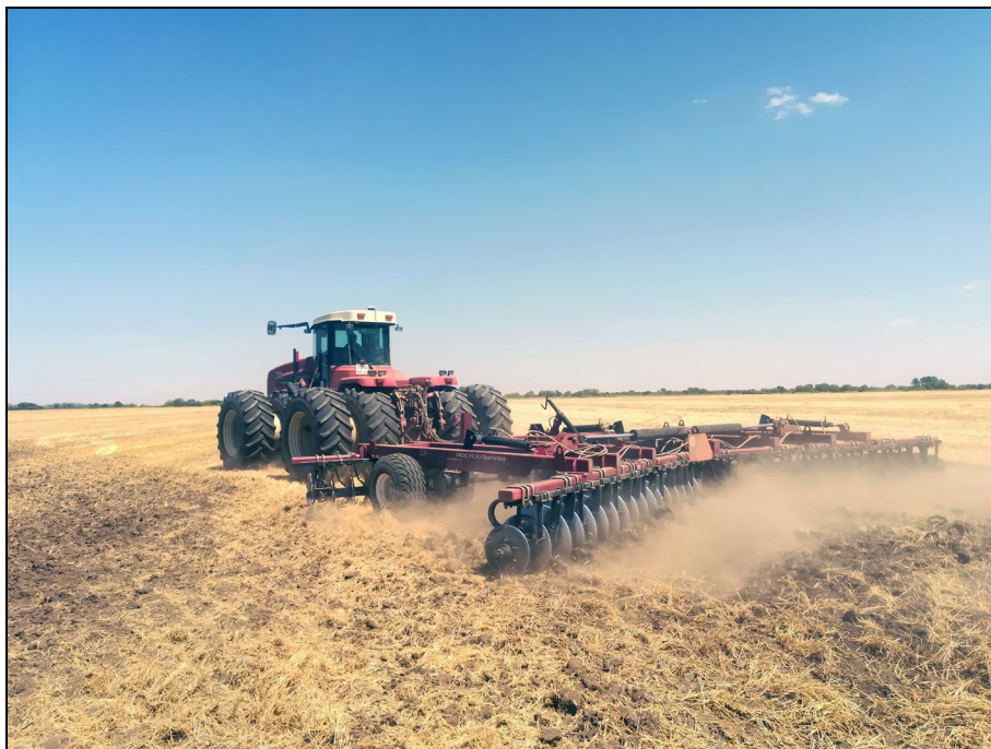
Рисунок 2 – Борона дисковая тандемная DX-850/880, в агрегате с трактором Versatile 2375 на дисковом лущении стерни озимой пшеницы (1 след)
