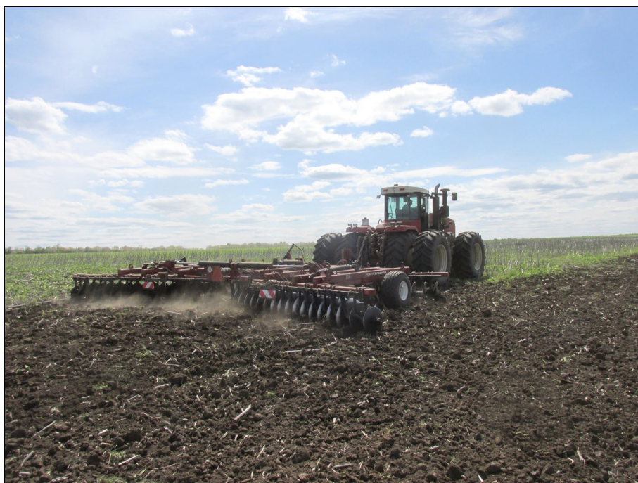
Рисунок 3 – Борона дисковая тандемная DX-850/880, в агрегате с трактором Versatile 2375 на дисковом лущении пожнивных остатков подсолнечника (1 след)
