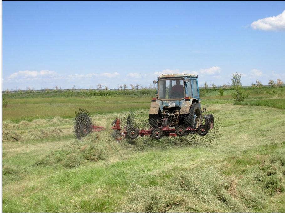
Рисунок 2 – Грабли колесно-пальцевые ГКП-600-01 "Kolibri V Plus" в агрегате с трактором МТЗ-80 на сгребании трав из прокосов в валки, обрачивании и ворошении валков сена
