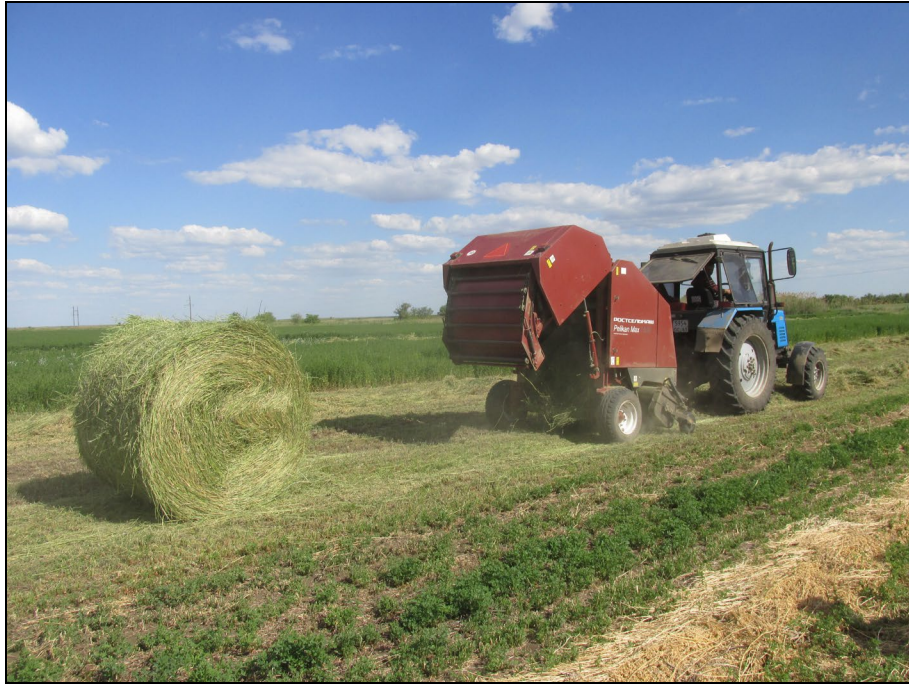
Рисунок 2 – Пресс-подборщик рулонный ППР-150 "Pelikan Max" в агрегате с трактором Беларус 892 на подборе и прессовании валков сена в рулоны с обмоткой их шпагатом
