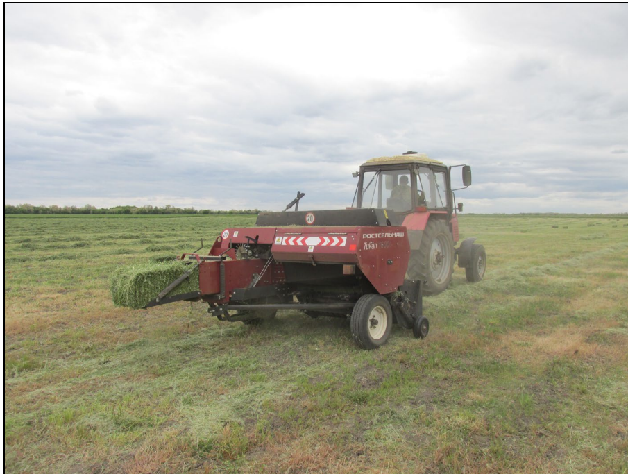
Рисунок 2 – Пресс-подборщик тюковый ППТ-041 "Тукан" в агрегате с трактором Беларус 892 на подборе и прессовании валков сена в тюки с обвязкой их шпагатом
