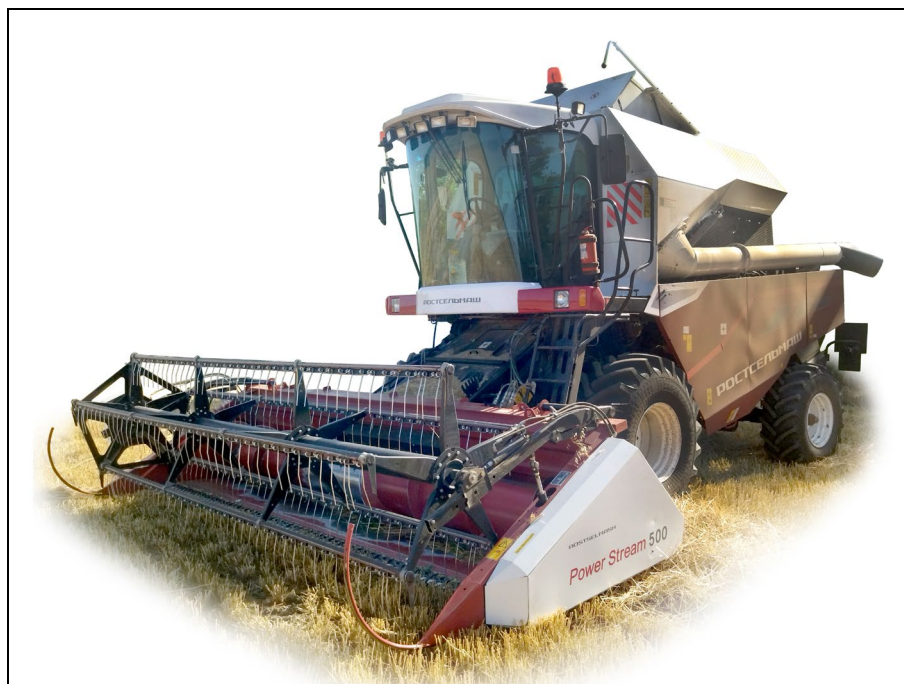
Рисунок 1 – Комбайн зерноуборочный самоходный S300 "NOVA-340"
