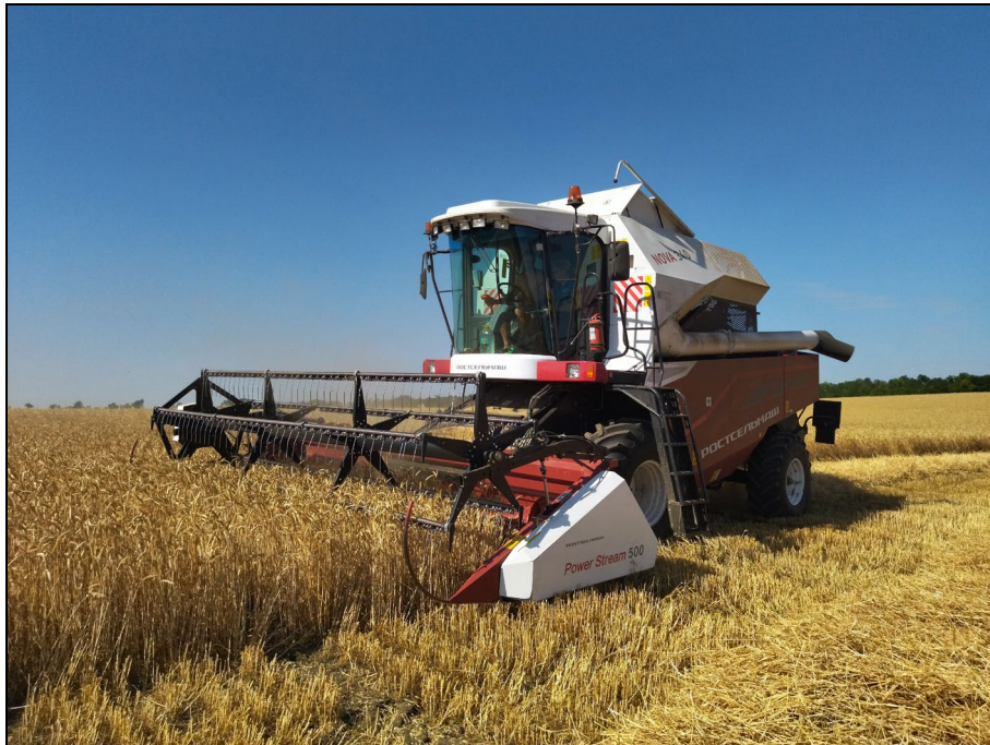
Рисунок 2 – Комбайн зерноуборочный самоходный S300 "NOVA-340", на прямом комбайнировании озимой пшеницы
