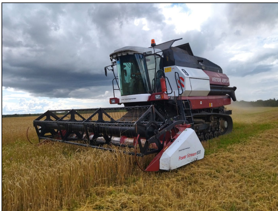
Рисунок 2 – Комбайн зерноуборочный самоходный РСМ-102 "Vector-450 Track", на прямом комбайнировании озимой пшеницы
