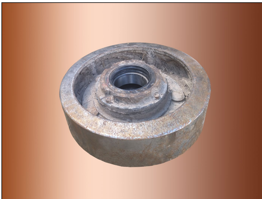
Рисунок А.1 – Разрушение подшипника опорного катка
