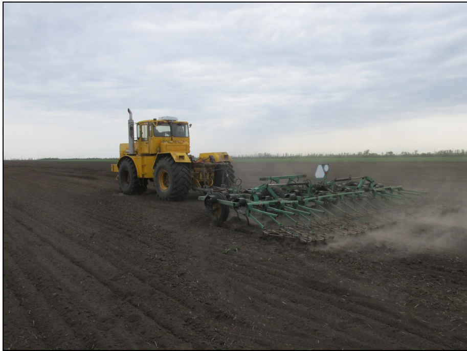
Рисунок 2 – Культиватор для сплошной обработки КСП-6-01 К10 "Атаван" в агрегате с трактором К-700 "Кировец", на предпосевной обработке почвы
