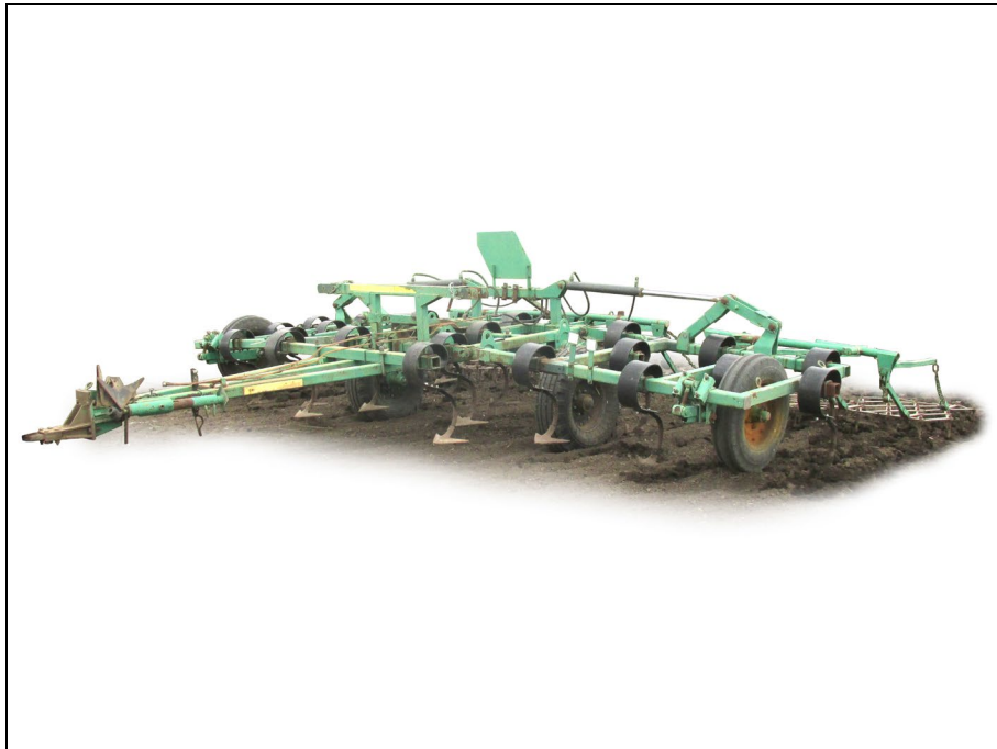
Рисунок 1 – Культиватор для сплошной обработки КСП-6-01 К10 "Атаван", вид спереди слева
