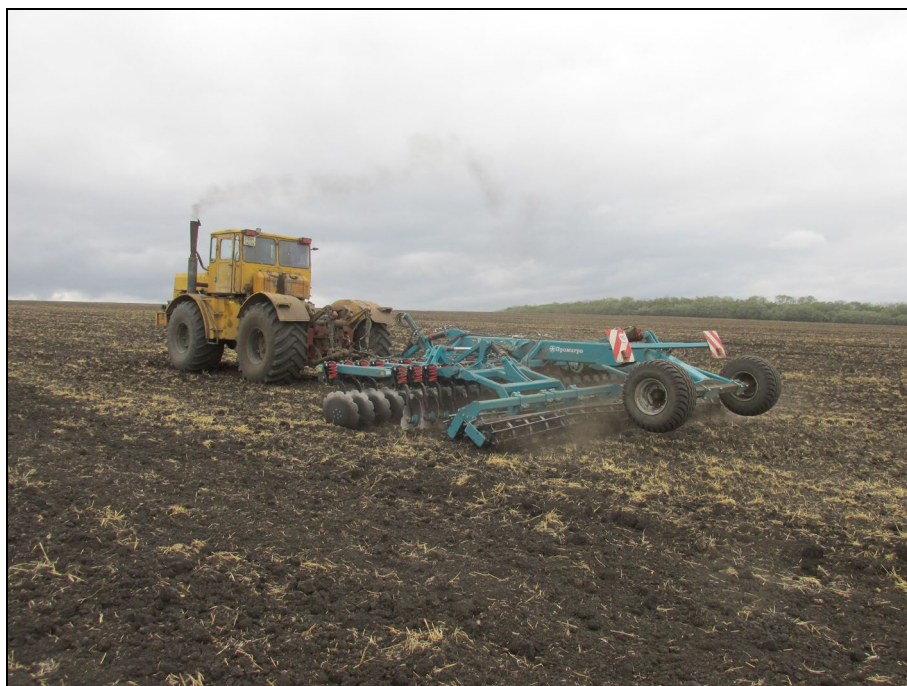
Рисунок 2 – Борона дисковая легкая полуприцепная складная ДЛ-620ПС М "Форвард" в агрегате с трактором К-701 "Кировец" на дисковом лушении стерни озимой пшеницы (2 след)
