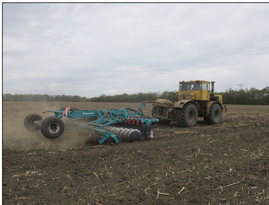
Рисунок 2 – Борона дисковая легкая полуприцепная складная ДЛ-620ПС М "Форвард" в агрегате с трактором К-701 "Кировец" на дисковом лушении пожнивных остатков подсолнечника (2 след)
