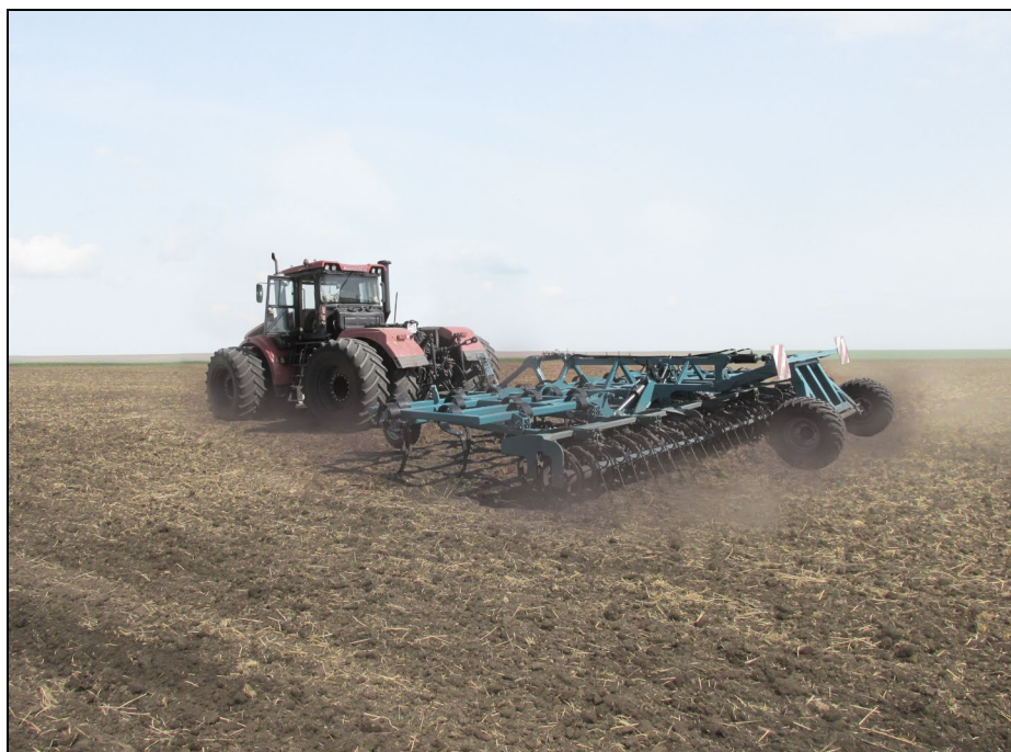
Рисунок 2 – Культиватор стерневой средней полуприцепной складной КСС-9000 М2 "Олимп" в агрегате с трактором К-744 Р1 "Кировец", на поверхностной обработке почвы
